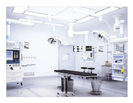
手术室净化车间安装:环境的要求:对手术室地面、墙面及室内面积要求手术室净化装修的使用面积应在充分考虑手术方式和对象前提下,以 25□ 45 m 2 为宜,墙壁和地面应光滑、无空隙,地面可以选用胶地板。层流手术室净化装修的墙壁应色彩柔和,光线明亮,且为可不用水冲洗清洁的具有抑菌作用的特殊涂料粉刷。对高洁净度手术室位置要求 高洁净度的手术室须设于远端,专属于污染手术的负压手术室须设于近端,手术室净化装修的室内须设缓冲间,心、胸手术室须设置与手术室相通的储备间。
