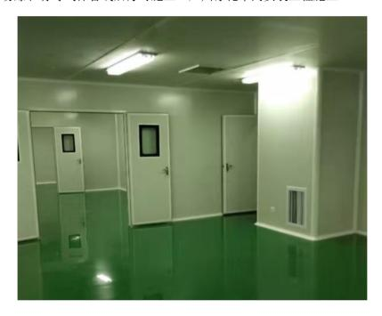
净化车间安装要求:净化车间施工必须与各专业工种间制定严格的施工程序,一般依次为:留洞打底、各专业安装、内门窗安装、修补洞口及周边、基层打底、饰面抹灰和罩面板工程、嵌缝处理、油漆刷浆工程和裱糊工程。在净化车间施工过程中,必须随时清扫灰尘,对隐蔽空间(如吊顶和夹墙内部等)还应做好清扫记录。应保护已完成的装饰工程表面,不得因撞击、敲打、多水作业等造成板材凹陷、暗裂和表面装饰的污染。对已安装高效过滤器的房间,不得进行有粉尘的作业。广州净化车间安装工程施工装配式净化车间施工安装缝隙,必须用密封胶密封。
